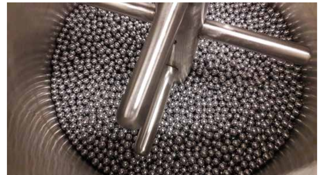
Figura 6 Impianto di raffinazione e omogeneizzazione a sfere
