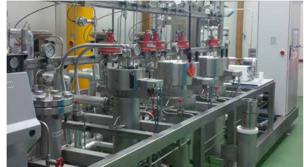
Figura 5 Impianto di estrazione supercritica (processo SFE)
